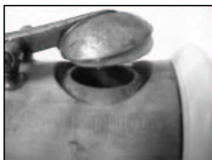
13. Foro svasato con sistema di chiusura dello stesso per mezzo di cuscinetto, brevettato da Iwan Müller.
